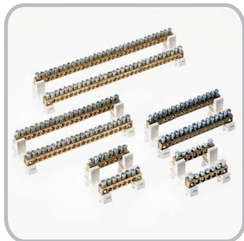
Le Morsettiere Bipolari disponibili per correnti da 63A si caratterizzano per l'agganciamento su tutte le Guide Din e a pannello. Il cablaggio di ogni conduttore è agevolato dall'invito conico dei fori d'ingresso e dalle viti antiallentamento fornite in posizione «tutto aperto». Sono disponibili a 5, 6, 14, 20 e 30 fori per barra.
